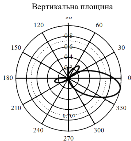
Рис. 9. Діаграма направленості синфазної антенної решітки.
