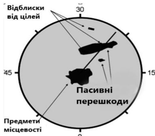
Рисунок 2 – Вид пасивної перешкоди на екрані ПП до компенсації
